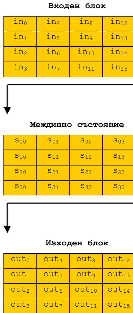
Фиг.21 Ход на преобразуването на данните, организиран във вид на блокове State
