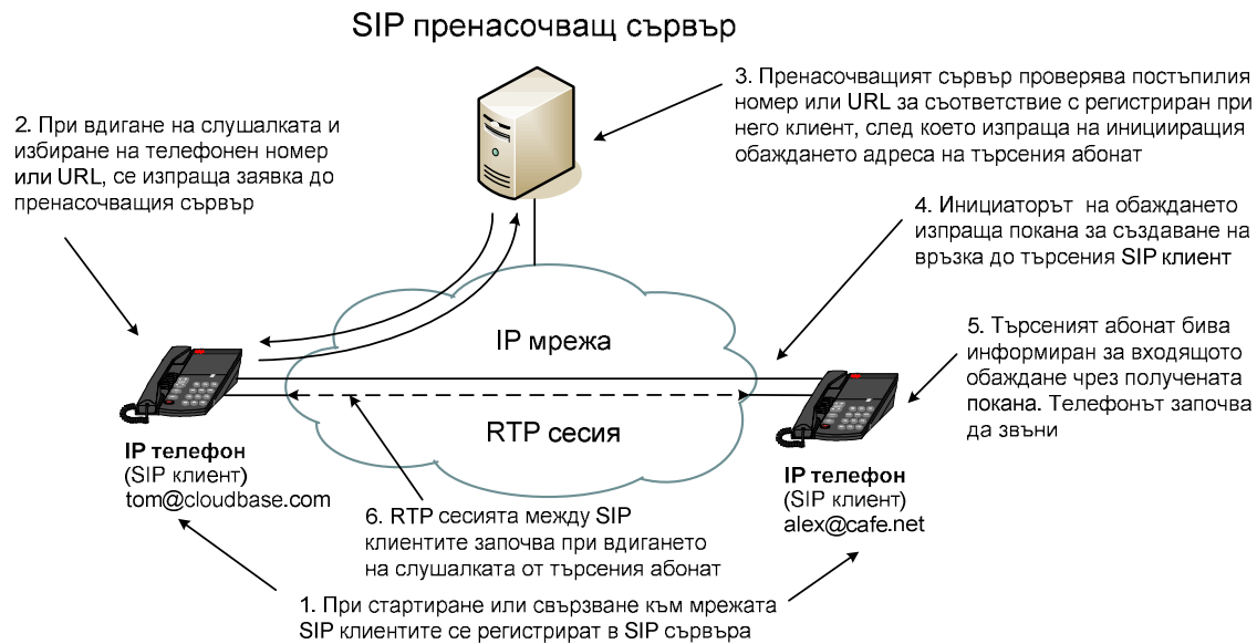
Фигура 4.3. Свързване на телефонно обаждане с използване на SIP сигнализация и пренасочващ сървър
