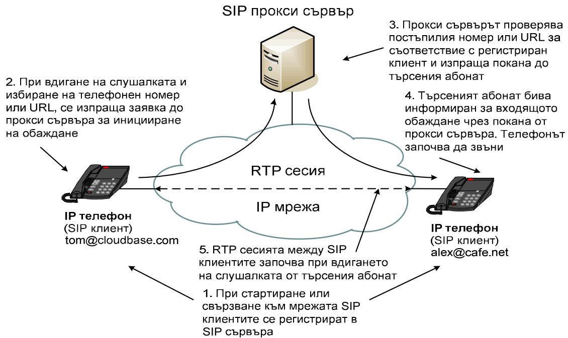
Фигура 4.2. Свързване на телефонно обаждане с използване на SIP сигнализация и прокси сървър
