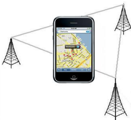
Фиг. 3. Пример за безжична триангулация
