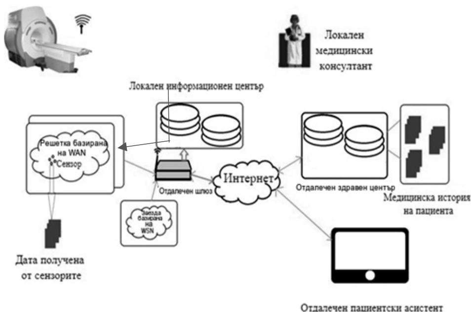
Фиг. 2. Схема на реализация на вътрешноболничната мрежа на различните умни устройства 12
