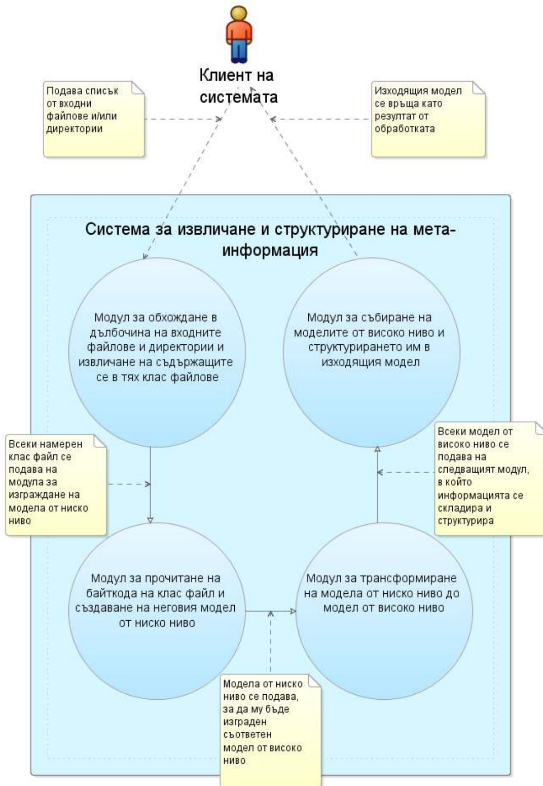
Фиг. 5: Архитектура на системата за извличане и структуриране на мета-информация
