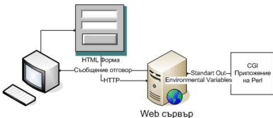
Фигура 3.2-1 – Основен принцип на работа при CGI
